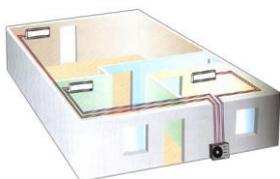
Per ogni unità abitativa è prevista la predisposizione dell'impianto di raffreddamento, costituito dalla fornitura e posa in opera di tubazioni coibentate collegate alla rete di distribuzione condominiale e linee di scarico della condensa per una futura installazione di split idronici. Si prevede un punto attacco interno per ogni locale camera e soggiorno (si escludono tutti i locali diversi da camere e soggiorni). La distribuzione
