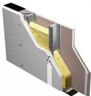
Le murature interne verranno realizzate in cartongesso, su ogni lato della struttura verrà montato un doppio strato di lastre in gesso rivestito dello spessore di 12,5 mm, all'interno della parete verrà posato uno strato isolante di idoneo spessore e densità. A discrezione della D.L. le murature interne potranno essere realizzate in mattoni forati di laterizio di spessore 8 – 12 cm. I muri realizzati in calcestruzzo armato nel box saranno lasciati a vista (non
