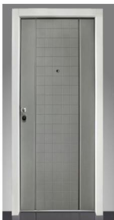
Tutte le unità abitative saranno dotate di un portoncino di ingresso di sicurezza della ditta "DIERRE MODELLO TABLET PLUS 8" o similare, certificata in classe 3 secondo la norma europea ENV 1627-1 con serratura a cilindro di alta sicurezza con rivestimento interno con pannello liscio (esterno a doghe o in pannelli pantografati in compensato marino), posato saldamente affrancato alla struttura muraria, completa di serratura e maniglia ottonata.
